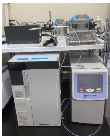
Fig. 2 (a) GC-pyrolysis-AFS システム概略図、(b) 装置外観 (写真)
