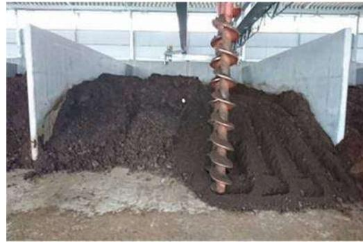
Fig. 16 可動式スクリュウ攪拌機
